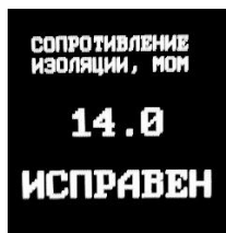
Рис.6. Информация на дисплее (тест сопротивления):
