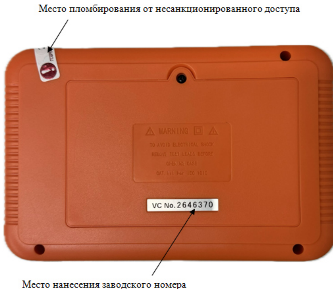
Рисунок 8 – Место нанесения заводского номера и место пломбирования от несанкционированного доступа
