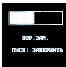
Рис 5. Наличие дефекта катушки, уложенной в пазы.
