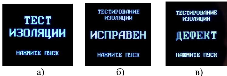
Рис.5. Информация на дисплее (тест сопротивления): а) меню измерения, б) сопротивление больше 0.5 МОм, в) сопротивление меньше 0.5 МОм.
