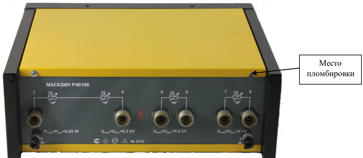
Рисунок 2 – Схема пломбировки от несанкционированного доступа.
