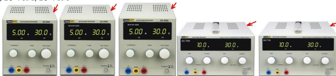
Рисунок 2 – Схема пломбировки от несанкционированного доступа.
